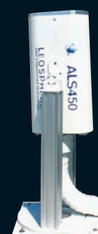
Ci-dessous, de gauche à droite : Suivi en temps réel des couches d'aérosol dans la troposphère permettant de détecter des phénomènes complexes (ex : passage en altitude d'épisodes de pollution émanant du désert de Gobi) ainsi que d'alimenter le modèle de prévision régional de la qualité de l'air – Portée 20km.
